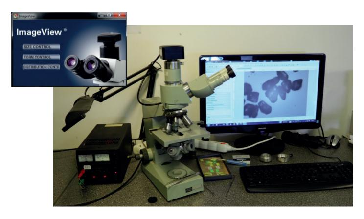
Ein Zeiss Mikroskop mit einem hochauflösenden CMOS Bildsensor ermöglich zusammen mit der VideoTest Spezialsoftware eine Präzise Messung von Form- und Größenverteilung der Diamantpartikel. Diese Methode ist vergleichsweise langsam, ermöglicht jedoch eine sehr hohe Messgenauigkeit und eine visuelle Darstellung von Körnern mit einer Korngröße von 3 µm und mehr.
